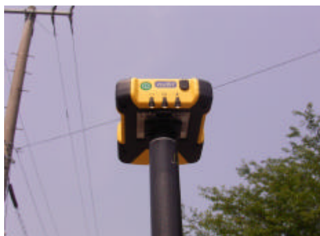
写真左 :Pathfinder ProXHをキネマポールにセットした状態 本体に専用取付けアダプタをセットしてキネマポールに取り付けます)
