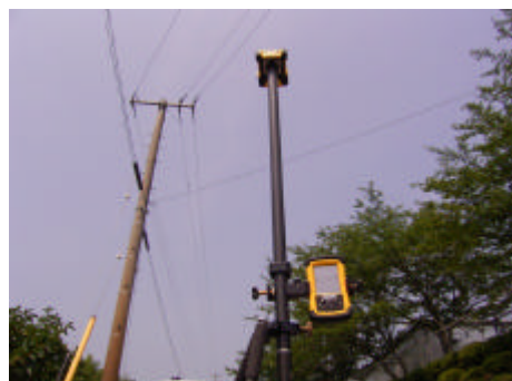
写真左 :Pathfinder ProXHをキネマポールにセットした状態 本体に専用取付けアダプタをセットしてキネマポールに取り付けます)
