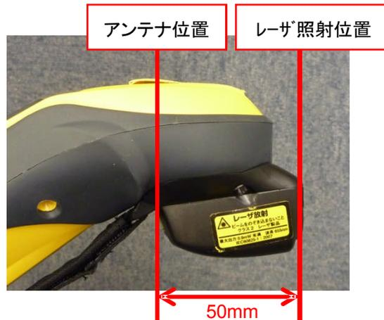
GNSS アンテナ位置とレーザー照射結果の整合性を確保するため、Rangefinder 計測結果の内、距離結果に
