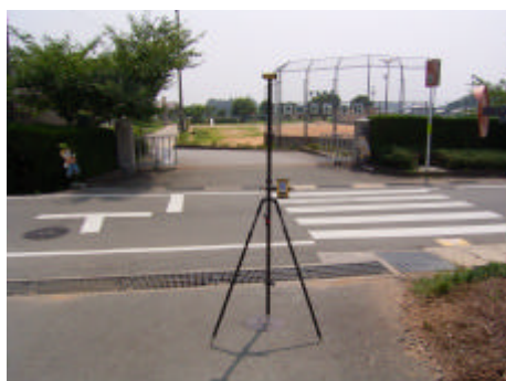
写真右 :Pathfinder ProXHによる観測スタイル (Reconから携帯モデム&携帯電話が付属する)
